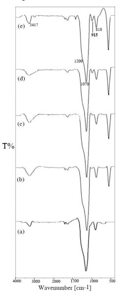
Fig. 1. FTIR spectra of (a)MCF; (b) 1.4V-MCF; (c)2.8V-MCF; (d)4.2V-MCF; (e)5.6V-MCF.
