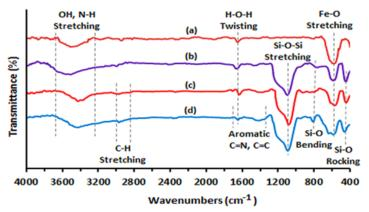
Fig. 1. The FT-IR spectrum of (a) Fe<sub>3</sub>O<sub>4</sub>, (b) Fe<sub>3</sub>O<sub>4</sub>@SiO<sub>2</sub>, (c) Fe<sub>3</sub>O<sub>4</sub>@SiO<sub>2</sub>-PrCl, and (d) Fe<sub>3</sub>O<sub>4</sub>@SiO<sub>2</sub>-AQ.
